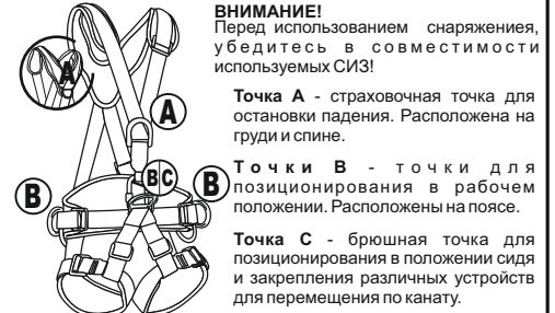
Рис. 3. Типы крепёжных точек страховочной привязи
